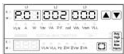
Esempio impostazione rapporto TA a 200 (1000 / 5) Example of CT ratio set to 200 (1000 / 5) Exemple de réglage rapport T1 à 200 (1000 / 5) Ejemplo programación valores en TA a 200 (1000 / 5)
