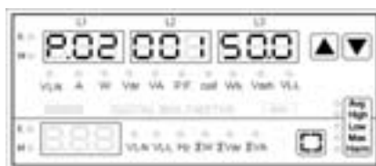
Esempio impostazione rapporto TV a 150 (15000 / 100) Example of VT ratio set to 150 (15000 / 100) Exemple de réglage rapport TP à 150 (15000 / 100) Ejemplo programación valores en TV a 150 (15000 / 100)
