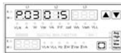
Esempio impostazione tempo integrazione potenza a 15 min. Example of power integration time set to 15 minutes Exemple de réglage du temps d'intégration à 15 minutes Ejemplo programación tiempo de integración de potencia a 15 min.
